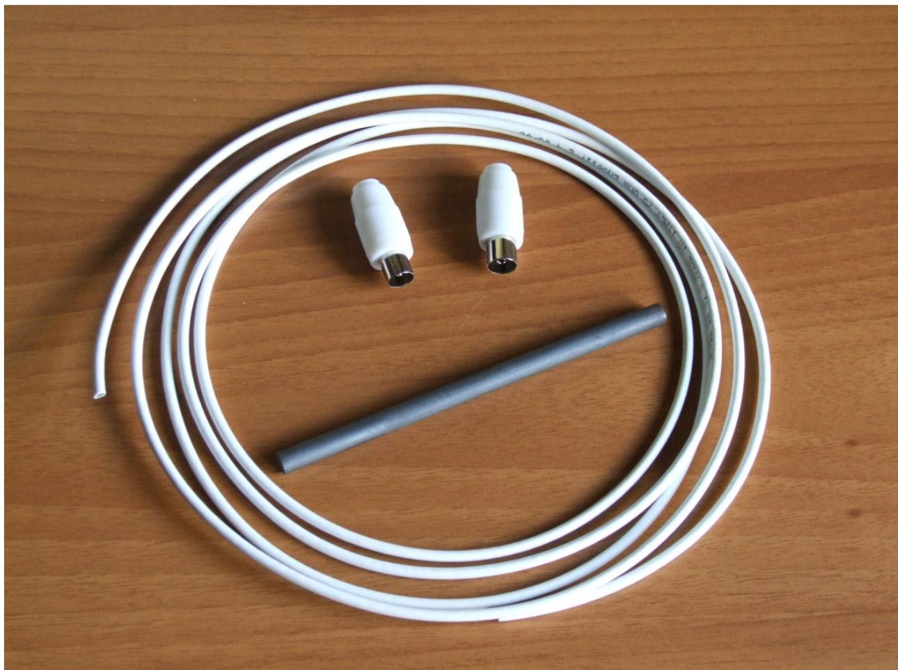
Avvolgete circa 24 - 25 spire, ben strette, del cavo attorno alla ferrite lasciando due codini di cavo per parte, di circa 100mm. Fissate le spire col nastro adesivo e le fascette. Infine intestate i due connettori alle estremità del cavo facendo attenzione perché il filo centrale è molto sottile e scivola nel serrafilo del connettore. Quindi occorre ingrossarlo saldandogli in fianco un pezzetto di filo di rame più grosso. Saldate anche la calza al connettore per migliorarne il contatto.
